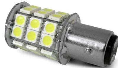
Questa lampadina grazie all'elettronica integrata è in grado di sostituire le comuni lampadine a incandescenza a 12 e 24 Volt alimentate in continua. L'attacco BAY15D è spesso utilizzato nella luce di fonda e nelle luci di navigazione. Questo tipo di attacco a baionetta presenta i due "piedini" laterali di fissaggio a un'altezza differente e due poli per l'alimentazione. Le sue caratteristiche principali sono:
