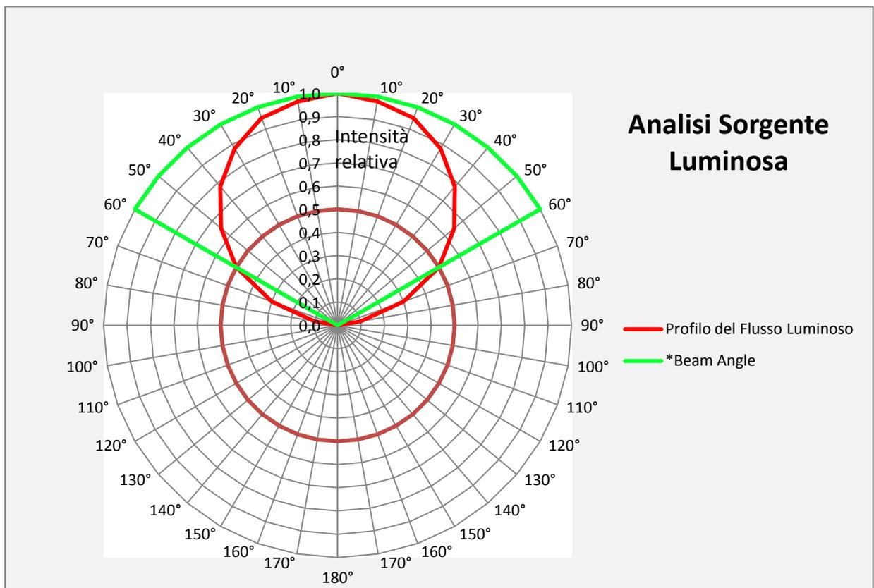
\* Il *Beam Angle* è l'angolo compreso tra gli assi per i quali il valore dell'intensità luminosa vale la metà della massima intensità luminosa
